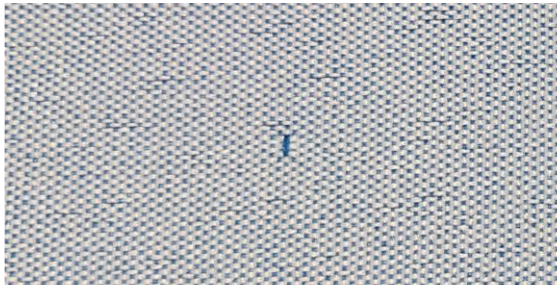
Abbildung 1: Gewebe mit Fehler / woven fabric with defect [Quelle: ITA]
