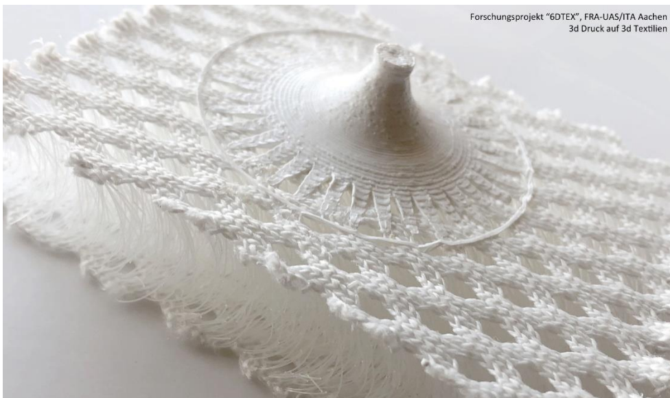
Abbildung 1: 3D-Druck auf 3D-Textilien, Projekt „6dTEX“ FRA-UAS
