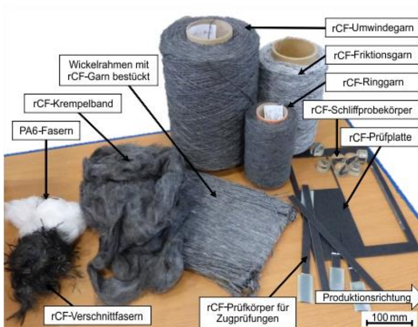
Abb. 1: Erzeugnisse der einzelnen rCF-Recyclingprozessschritte
