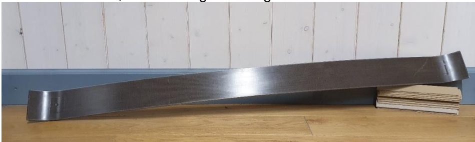
Abb.1: NFK-Demonstrator einer Blattfeder für ein Drehgestell einer Schmalspurbahn gebaut von NOVACOM Verstärkte Kunststoffe GmbH, Aachen
