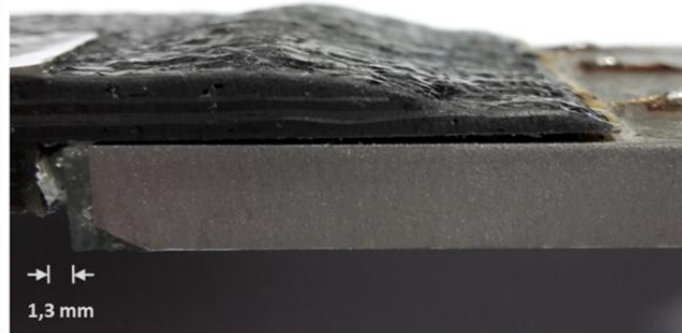
Abbildung 2: Detail einer Fügestelle nach dem adhäsiven Versagen
