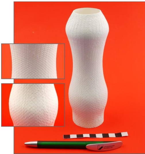
Abb. 1: Über das Freeze-Casting-Verfahren hergestelltes OFC-Bauteil
