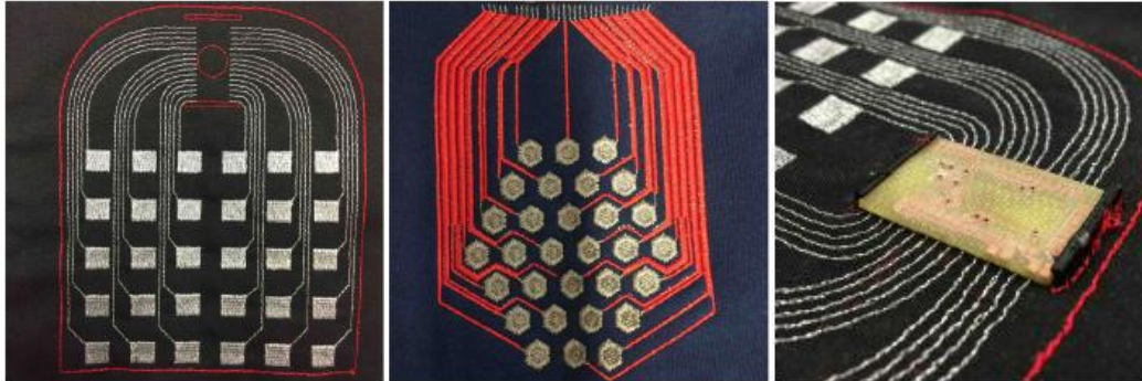
Abbildung 4: Erste textile sensorische Eingabematrizen auf Basis quadratischer (links) und sechseckiger Flächen (mittig), sowie Leiterbahnen zur Signalübertragung; Sensortextil mit kontaktiertem Auslesechip (rechts)
